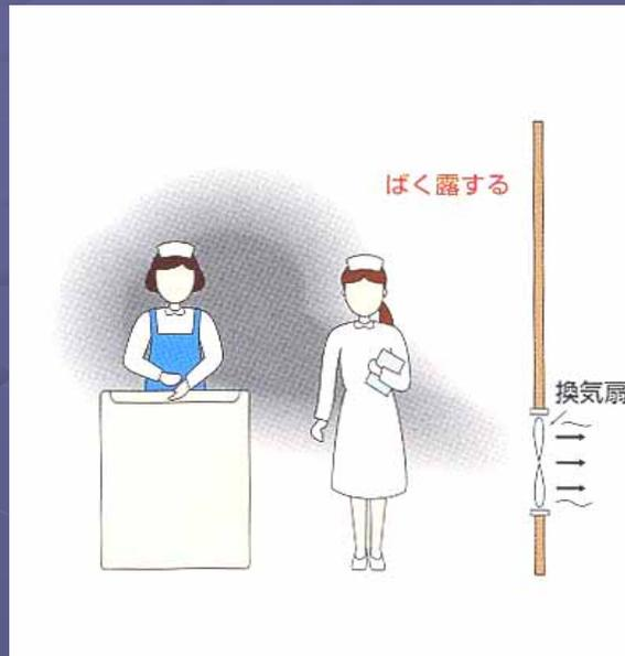
発散源から一度拡散したホルムアルデヒドが、徐々に薄まり、排気される。発散源対策にはならない。**補助的な換気装置**
